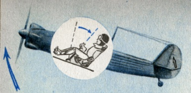
Летчик тянет ручку управления на себя — руль высоты отклоняется вверх, и весь самолет начинает набирать высоту.
